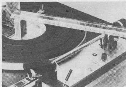
afb. 8 Dual meting afstand toonarmlager tot plateaulager.
