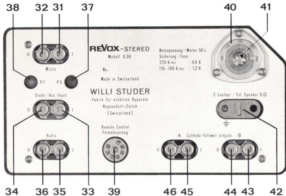
Nach Entfernen des Rückwanddeckels wird die Anschlussplatte, an der auch das Netzkabel angebracht ist, sichtbar.
