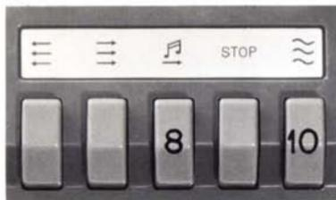
Bei gleichzeitigem Drücken der Tasten 8 und 10 läuft das Band und die Aufnahme erfolgt.
