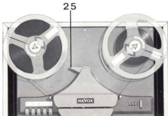
Wird eine kleine Vorratsbandspule (bis 18 Zentimeter Aussendurchmesser) verwendet, so ist der Bandzugumschalter 25 derart umzuschalten, dass sein Sperrhebel aus der Kopfabdeckung herausragt. Er verhindert, dass in dieser Stellung versehentlich eine grosse Bandspule auf den linken Spulenteller gelegt wird. Auf beiden Seiten sollten immer möglichst gleich grosse Spulen verwendet werden.
