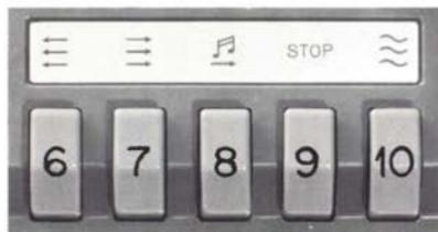
Die Steuerung des Bandtransportes erfolgt mit dem Drucktastenaggregat 6–10. Mit den einzelnen Tasten sind folgende Betriebsfunktionen zu schalten:
